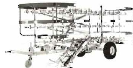
**Remolque autocargador descargador de pacas KEMPER** (alemán). Anchura 2,48 m., circulable por carretera, 3.000 pacas diarias, almacenamiento en el remolque con cadena sinfin, descarga mediante tobogan de salida. Capacidad de 75, 95 y 125 pacas según modelos. Potencia requerida de un tractor de 40 CV.
