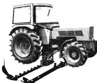
**Barra guadadora BUSATIS** de acople lateral al tractor, dos tipos distintos de cuchillas de corte.
