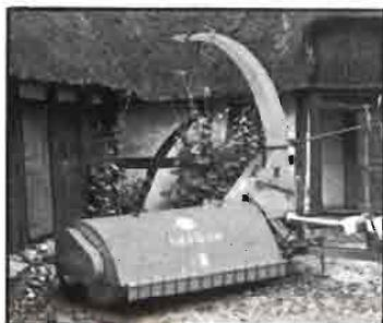
Cosechadora de forraje TAARUP-502. Triple corte. Equipada con dos contracuchillas. Potencia requerida, desde 60 CV. Ancho corte 1,83 m.
