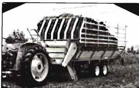
Autocargadora de forraje MIPA, serie Attila, tipos mono eje K-20, M-22, P-33, GR-44 y doble eje tipo DA-55. (Peso con carga de 2.600 a 4.500 kg, peso en vacío de 1.200 a 1.700 kg).
