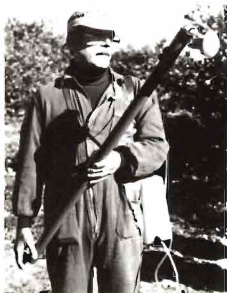
Pulverizador BERTHOUD, ULV, que funciona con pilas.
