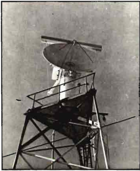
Pantalla de radar, montada sobre una base-torre metálica permite ser desmontada en 24 horas.
