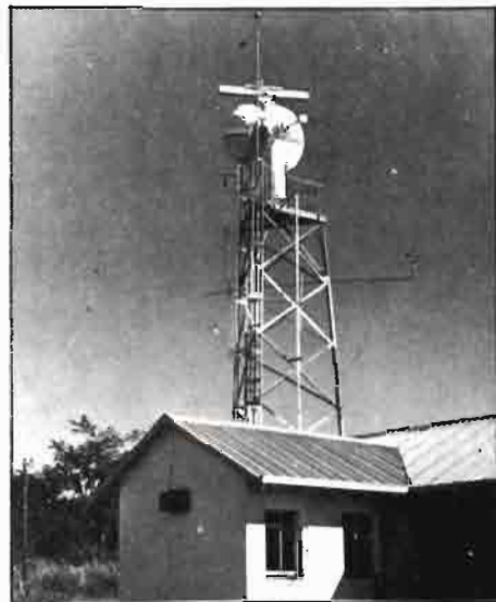
Radar meteorológico instalado en la base de operaciones de lucha antigranizo de Nelspruit (Sud-Africa); este equipo tiene un alcance de 150 Km de radio y puede estudiar formaciones nubosas ocultas por otras.
