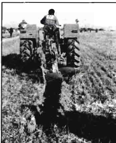
El surco de apertura inicia las pruebas, en este caso en rastrojo. El arado de vertedera bisurco ajustado a la eficacia de la labor de cara a los campeonatos es bastante decisivo.
