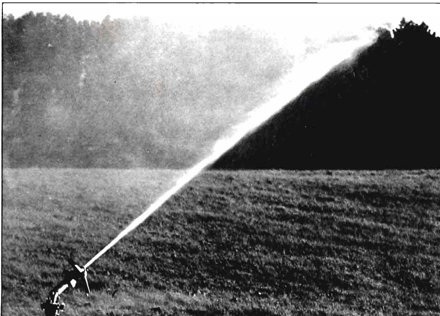
Aspesor tipo "cañón" de gran alcance y gran precisión en boquilla
