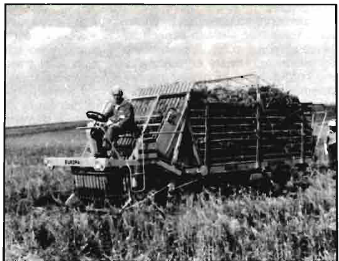
Remolque auto-cargador, marca Europa, modelo italiano, trabajando en forraje de cebada-veza en Toledo.
