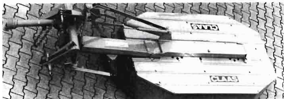
Guadañadora rotativa CLAAS WM 24, para una anchura de trabajo de 1,85 m.
