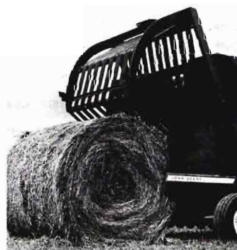
La empacadora cilíndrica 510 produce pacas de mayor presión, y de hasta 770 kilos de peso.
