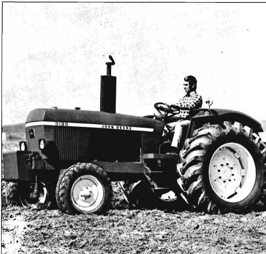
Moderno tractor agrícola John Deere de 90 CV, ejemplo de la fabricación actual española
