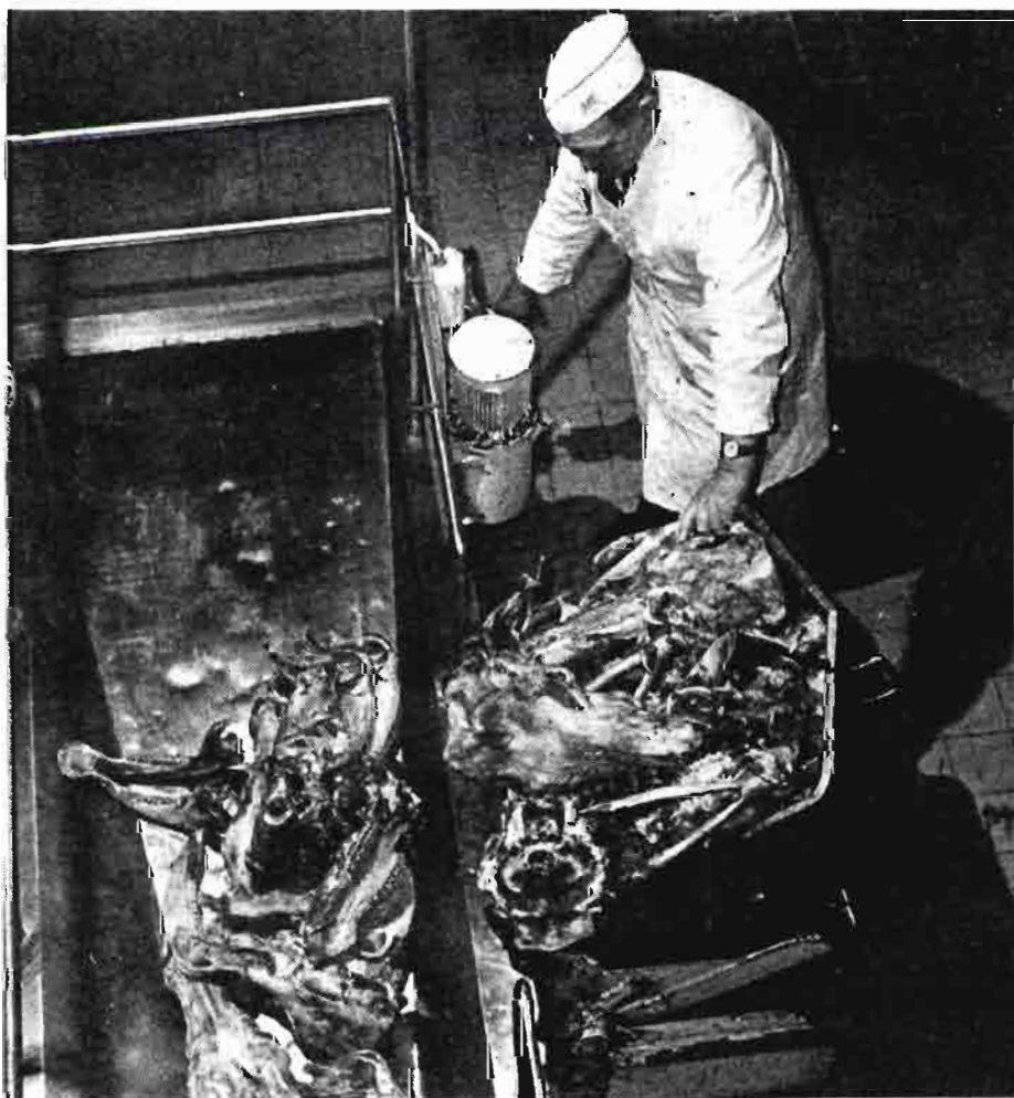
Recepción y molido previo de residuos cárnicos para su posterior procesamiento
