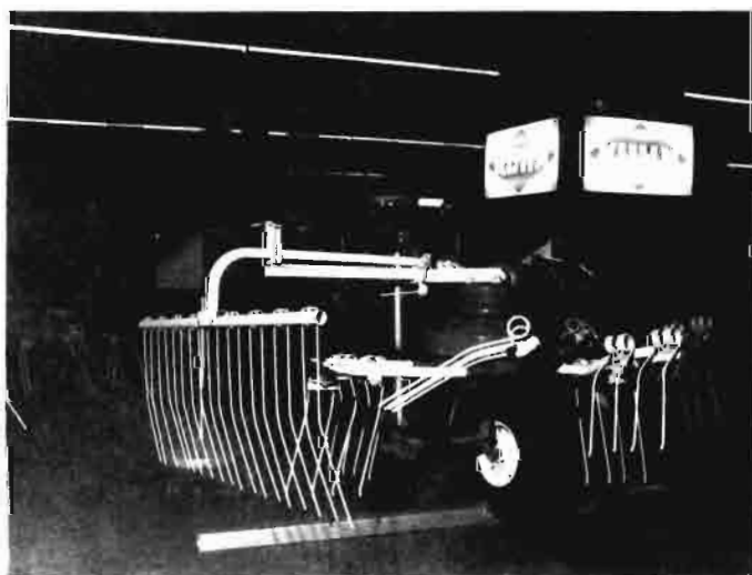
Henificador hilerador. Tendencia hacia máquinas polivalentes, a fin de disminuir el número de aparatos y de pases. La transformación del henificado en hilerado se consigue pulsando simplemente un botón
