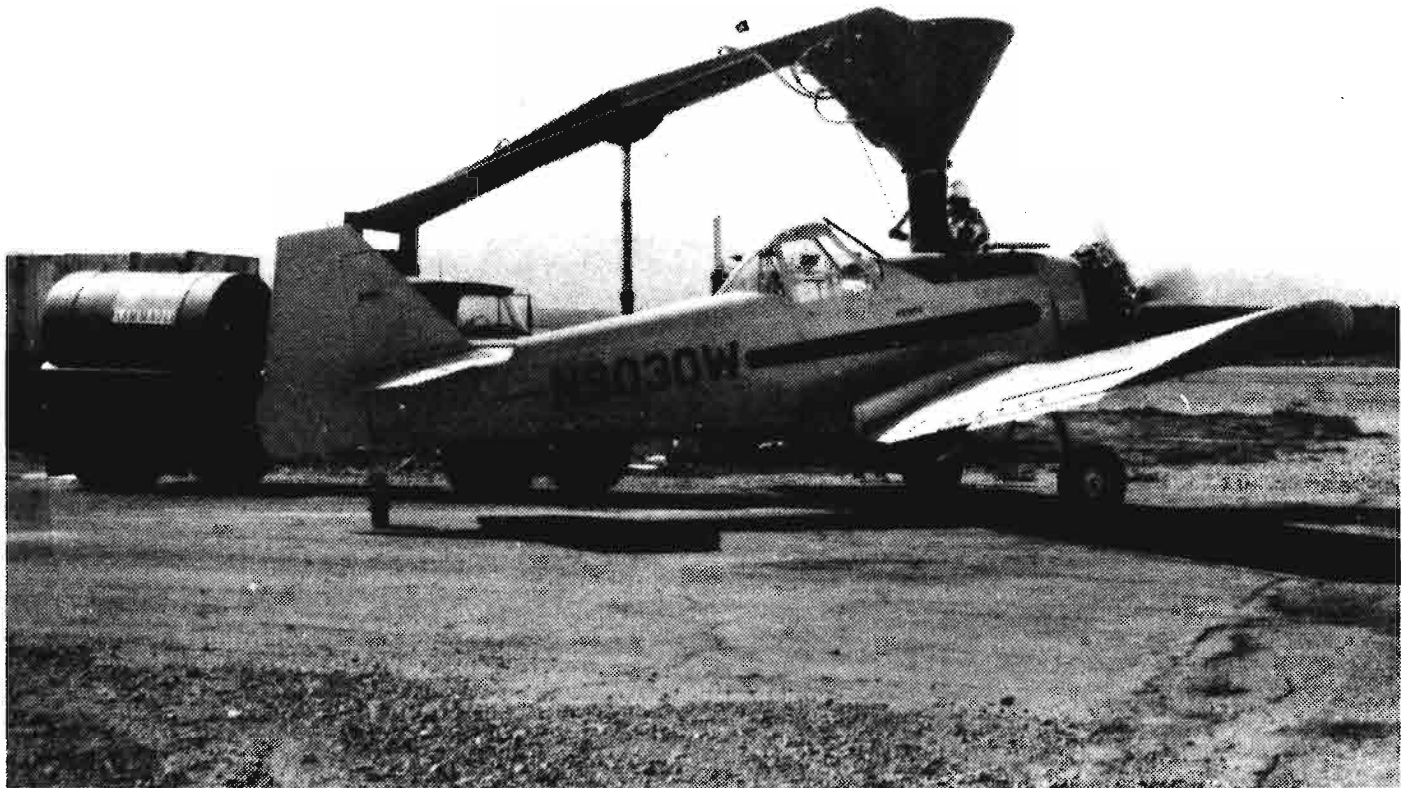
Carga automatizada por transferencia
