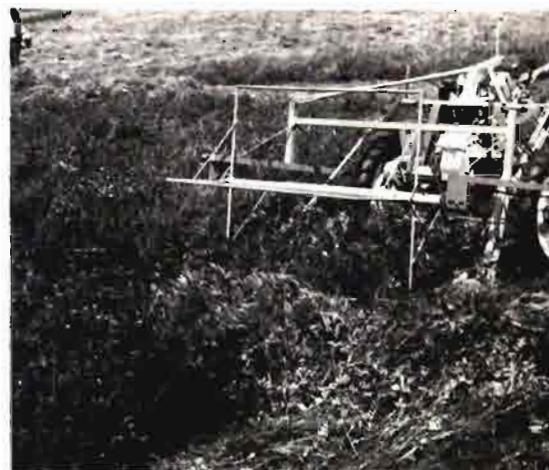
**SEGADORA-ROTATIVA** Morra, provista con dos rotores, con tres cuchillas oscilantes cada uno, y anchura de corte de 1,67 m.
