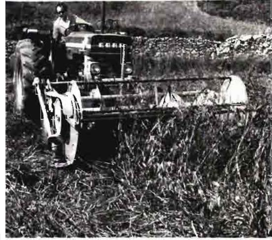
**SEGADORA-ACONDICIONADORA ZAZURCA.** El acondicionamiento del forraje, que facilita su secado y henuficación, se hace a base de un rodillo superior de caucho y otro inferior metálico estriado en V, que giran a 950 r. p. m.
