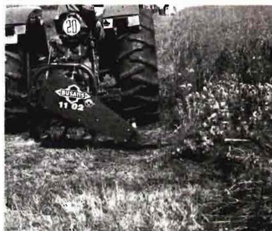
**SEGADORA-ACONDICIONADORA** J-F, con barra de siega de 2,10 m. y rodillos acondicionadores con presión regulable
