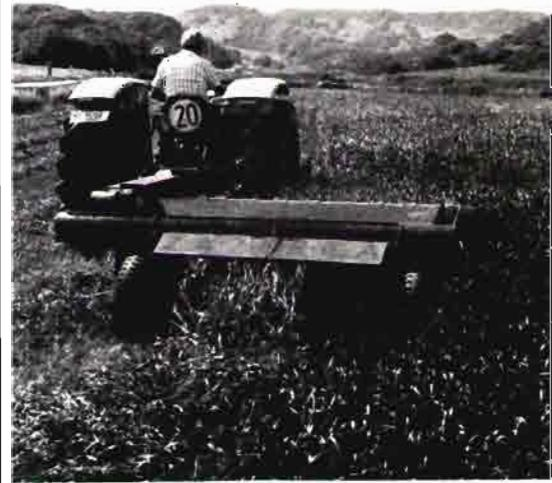
**REMOLQUE AUTOCARGADOR Weiger** que recoge una anchura de forraje de 1,54 metros. Capacidad de carga de 9,16 y 18 metros cúbicos
