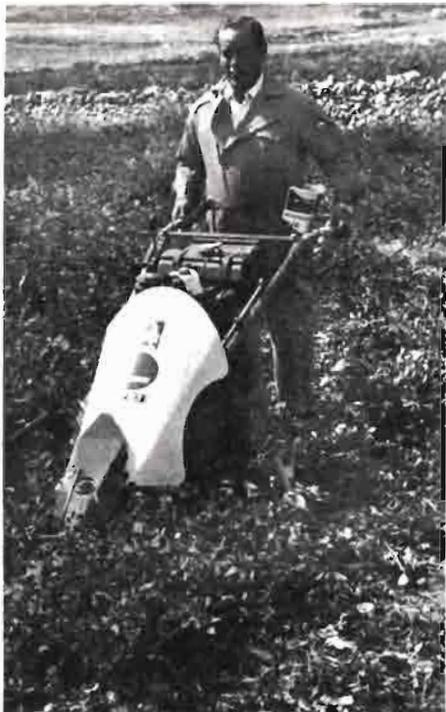
**MOTO-SEGADORA Alfa**, que puede ser equipada con distintos tipos de barra de siega. Se presentaron modelos con motores de gasolina y de gas-oil
