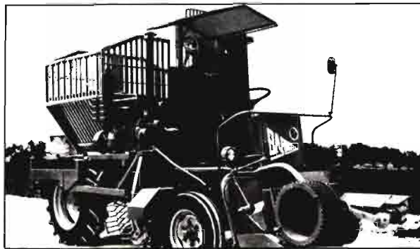
BOEING 747 MONOFILA AUTOPROPULSADA MOTOR 4 CILINDROS, 80 H. P. PRODUCCION: 3 Ha/JORNADA
