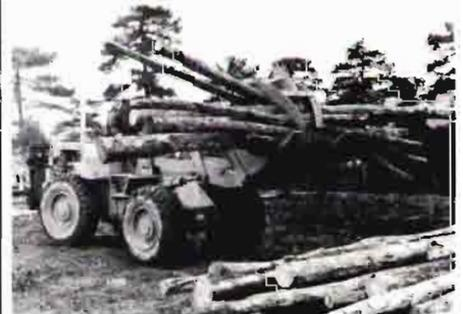
La saca de la madera se realizó bien mediante skider o **arrastradores**, accionados por tractores forestales, basados en el empleo de cables, o bien mediante **autocargadores**.
