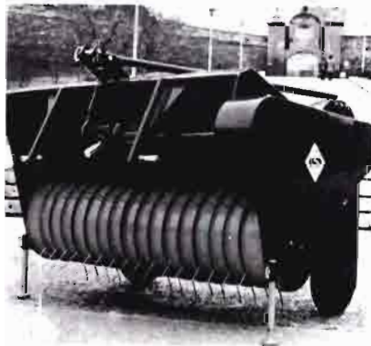
Triturador para la eliminación de restos de poda de vides y olivos
