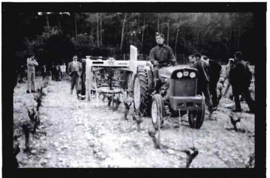
Tractor "viñero" de ruedas con máquina pre-podadora.
