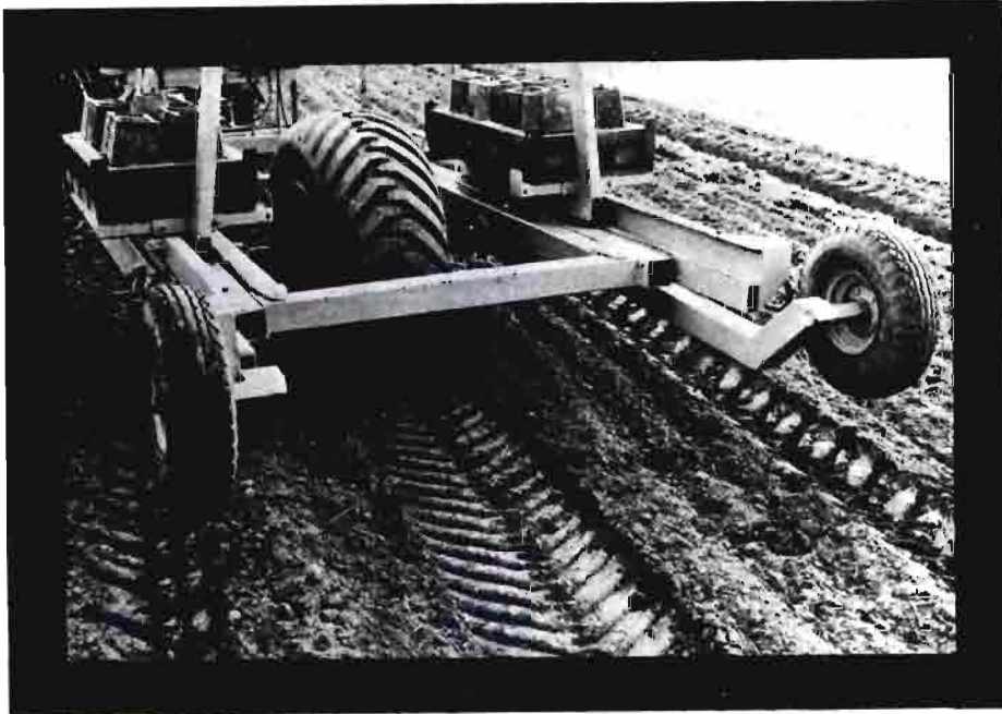
Carro dinamométrico para estudiar el engrane tierra-suelo (J. T. I.)
