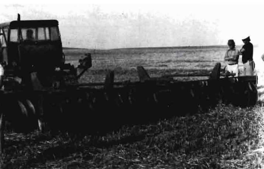
Arado de discos que consigue un enterrado inicial de las pajas
