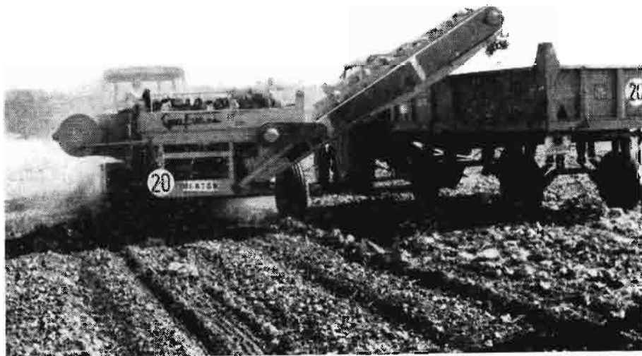
Despedregadora arrastrada a un tractor convencional y constituida por una cuchilla que penetra en el terreno en profundidad de 10-15 cm., llevando un volumen heterogéneo de tierra y piedras. La tierra es eliminada por los intersticios de una cadena longitudinal, llevando las piedras limpias a una cinta transversal que es la encargada de depositarlas en el remolque, como puede apreciarse en la fotografía.
