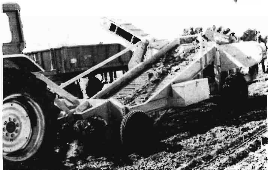
Vista frontal de una despedregadora de cadena en la que se observa el sistema extractor y la primera banda transportadora sobre la que se elimina la tierra.
