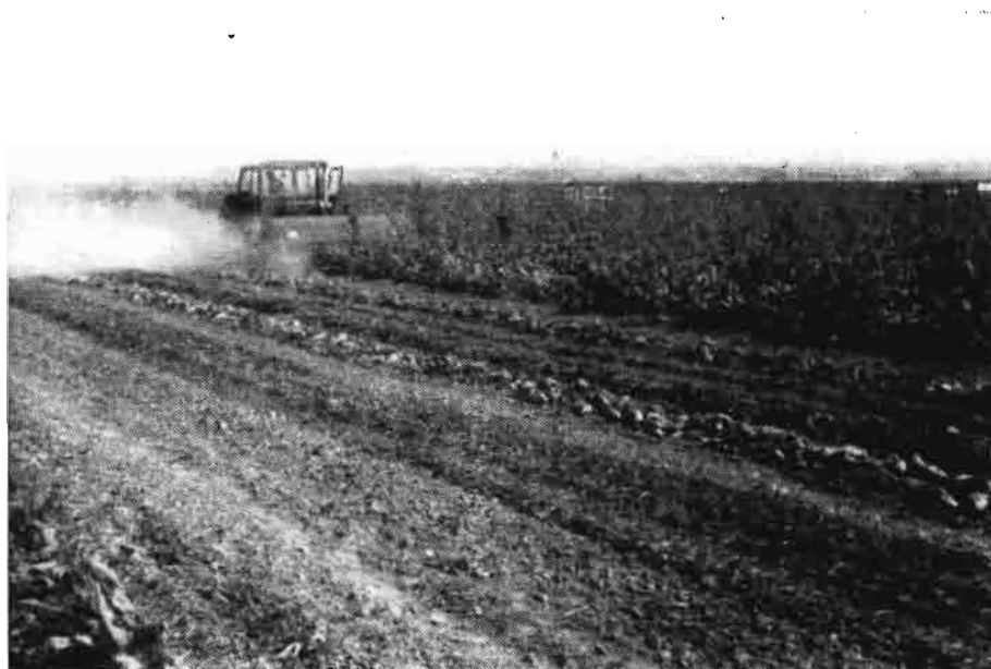
Descoronadora delante del tractor y arrancadora-hileradora detrás
