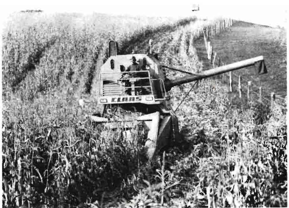
Las cosechadoras han de llevar la correspondiente protección para el conductor (barandillas en el acceso y en la plataforma, etc.).
