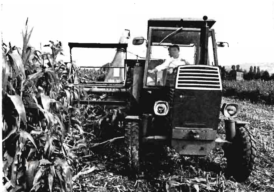
Las cabinas de seguridad de los tractores, además de preservar al conductor de las incidencias del tiempo, evitan el fatal accidente en la mayoría de los casos de vuelco.
