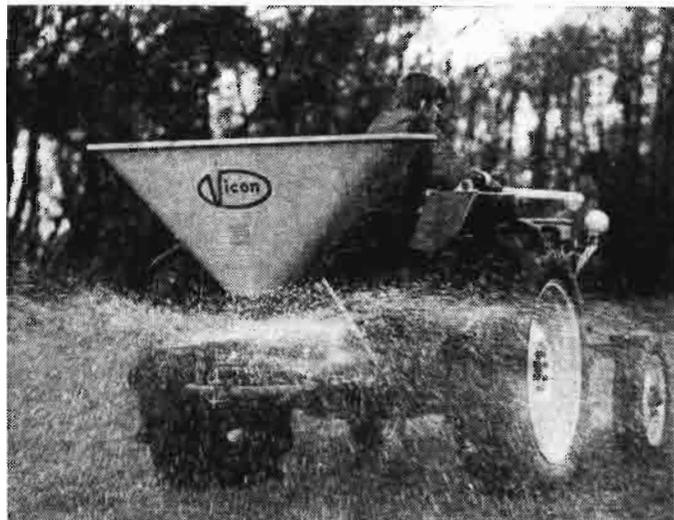
Abonadora pendular suspendida al enganche de tres puntos. El sistema distribuidor en esta máquina está compuesto de un tubo acodado en la base de la tolva que recibe un movimiento oscilante por excéntrica o biela manivela a través de un par cónico. El producto queda repartido sobre el terreno en una amplia banda al desplazarse alternativamente el conducto tubular de un lado a otro, describiendo un semicírculo
