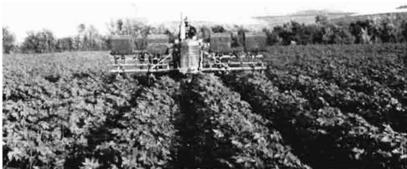
Un algodonal en el que las operaciones de preparación del terreno, siembra, labores, abonado, tratamientos y defoliación se realizaron mecánicamente, garantizando el perfecto trabajo posterior de la cosechadora. (Foto Alvaro Sierra Carre.)
