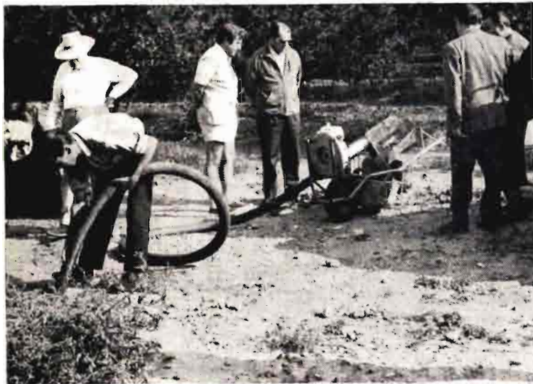
Vista completa de una máquina recogedora con manguera de aspiración en régimen de trabajo
