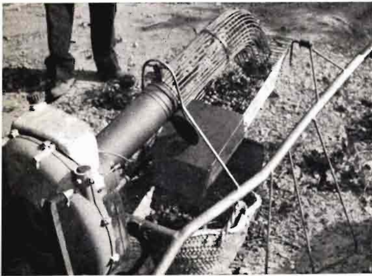
Recogedora neumática de gran simplicidad compuesta de un ventilador, un dispositivo venturí y una manguera de aspiración. A la salida de la manguera se dispone un emparrillado de varillas para la eliminación de impurezas que acompañen al fruto
