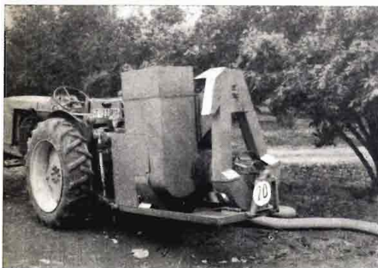
Recogedora-limpiadora arrastrada por un tractor, provista de mecanismo neumático de recogida por aspiración y dispositivo mecánico de limpia por tambor rotativo de varillas
