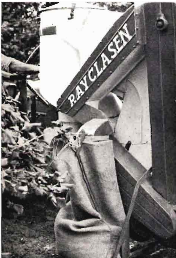
Máquina recogedora-limpiadora suspendida al enganche de tres puntos de un tractor. Se aprecia en la fotografía el conducto de salida del fruto limpio, que va depositándose en un saco colgado del bastidor
