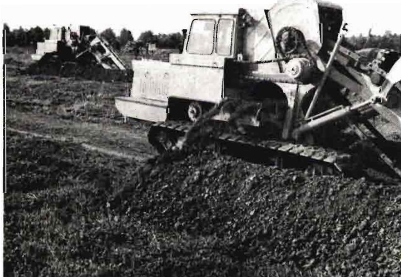
Abreanjas de cangilones continua con descarga lateral, trabajando en campos de Lituania. (Foto A. Brazaitis)
