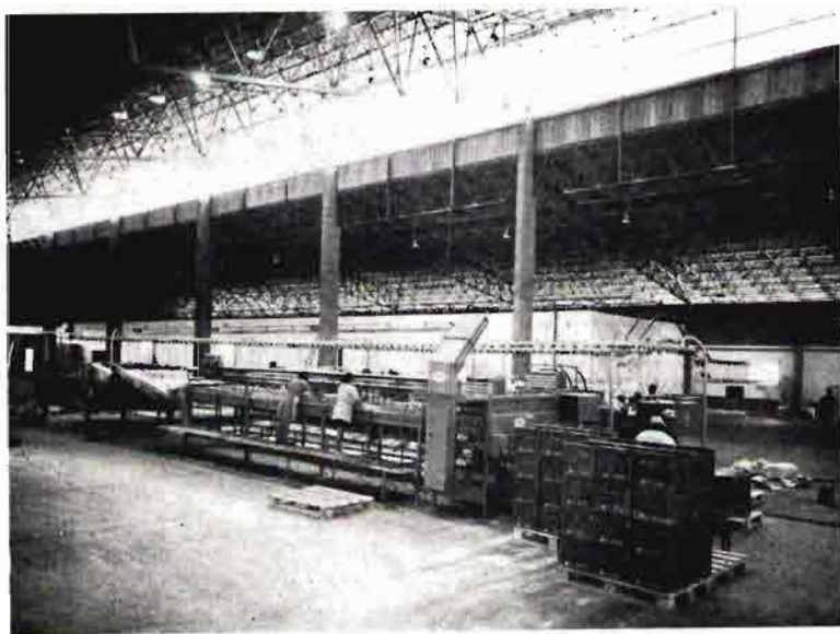
Mercoguardiana: Línea de clasificación de fruta, volcador automático de cajas, mesa de destribo y clasificadora de tamaños
