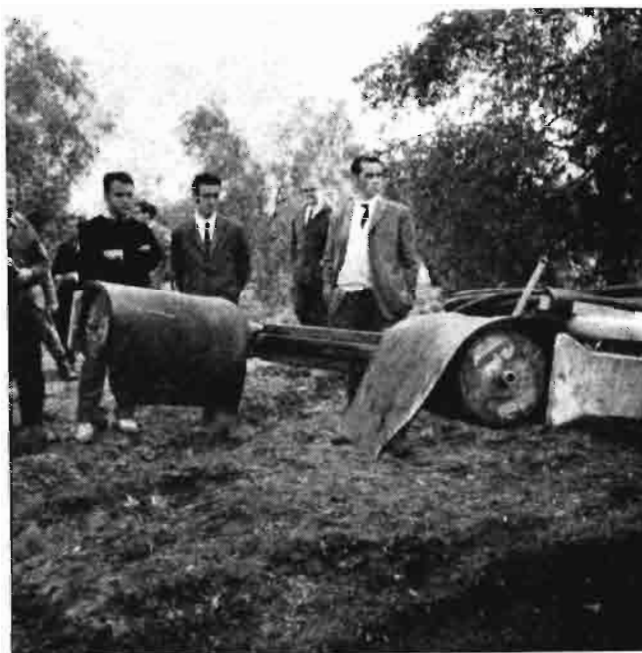
Sistema de mordaza frontal de la lanza del vibrador de gran potencia OMI, que quizá fuera interesante su adaptación a otro tipo que facilitara y disminuyera el tiempo de agarre al tronco del olivo
