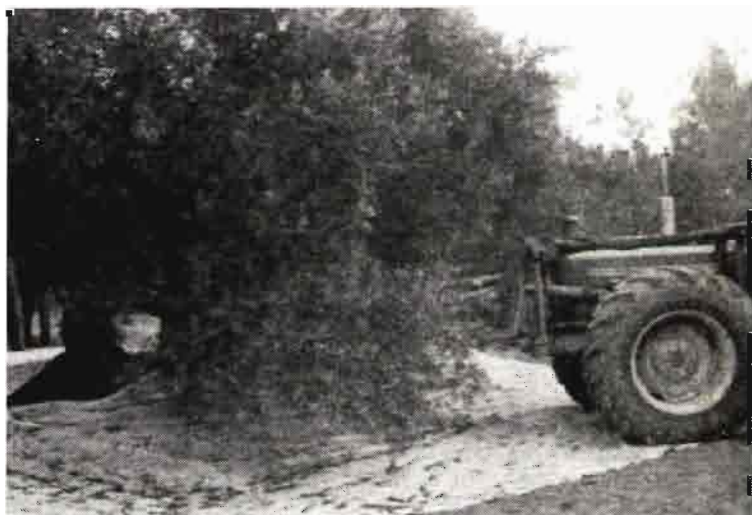
El vibrador OMI, atacando un olivo para el enganche del tronco, a fin de proceder a una rápida y potente vibración omnidireccional
