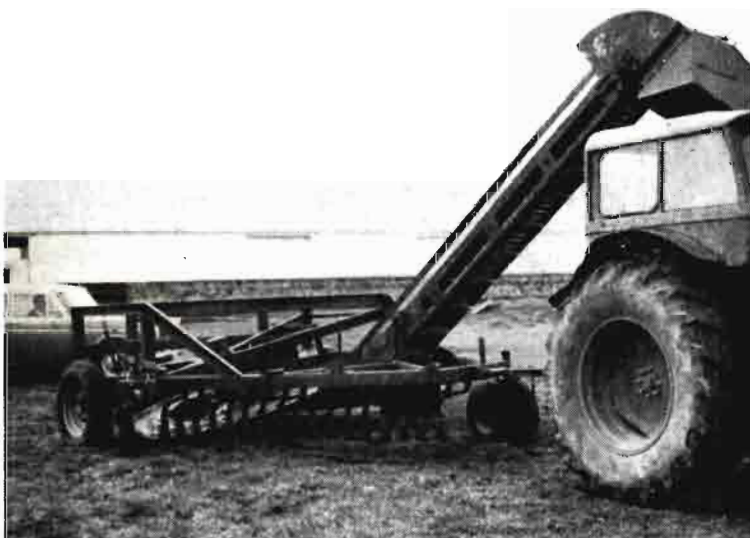
Despedregadora Bourne arrastrada. Un disco que gira al contacto con el suelo deposita las piedras, que le ha hilerado un rastrillo de púas flexible en una cadena elevadora que descarga directamente un camión o remolque
