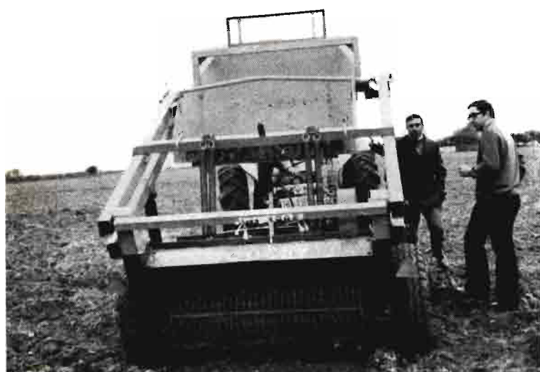
Despedregadora Doucet. El rodillo situado en la zona posterior de la máquina gira en el mismo sentido que la marcha, llevando como soporte una reja que deja escapar la tierra; las piedras salen lanzadas hacia adelante a una tolva que descarga hacia atrás y sobre camión por tener elevación hidráulica del mecanismo de descarga
