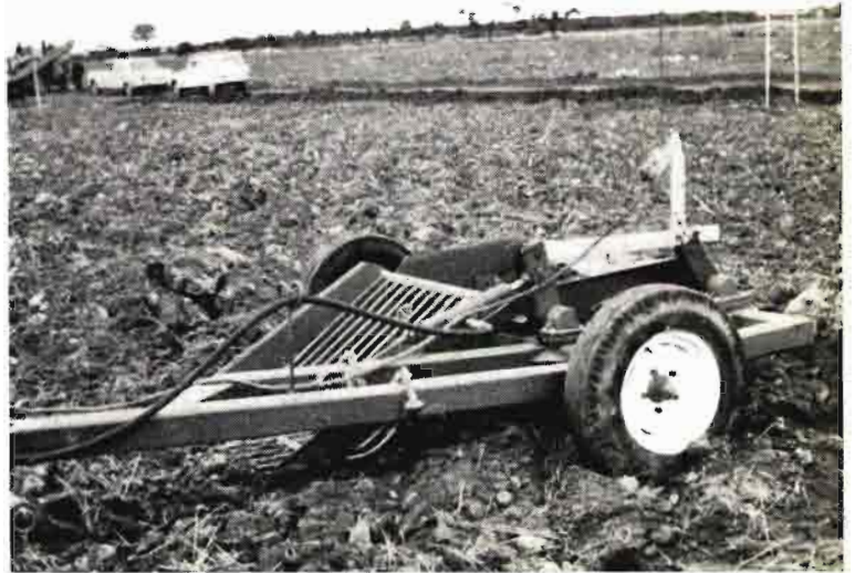
Rastrillo despedregador Westgo. El empuje realizado por una piedra sobre otra al avanzar la máquina hace que éstas asciendan hasta la tolva, que descarga por la parte posterior de la máquina en el lindero de la parcela
