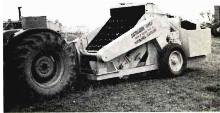
Rastrilladora-despedregadora Rambla. La serie de ganchos formando una banda continua sin fin son los encargados de rastrillar y elevar la piedra hasta una tolva con descarga lateral hidráulica
