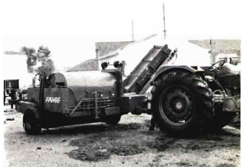
Despedregadora Fährse provista de cilindro giratorio con púas flexibles para evitar roturas por piedras superiores en tamaño a lo admisible. Tiene control hidráulico de profundidad de trabajo y descarga directa a remolque por medio de una cinta de varillas y pasando antes por una zaranda para efectuar una limpieza de la piedra
