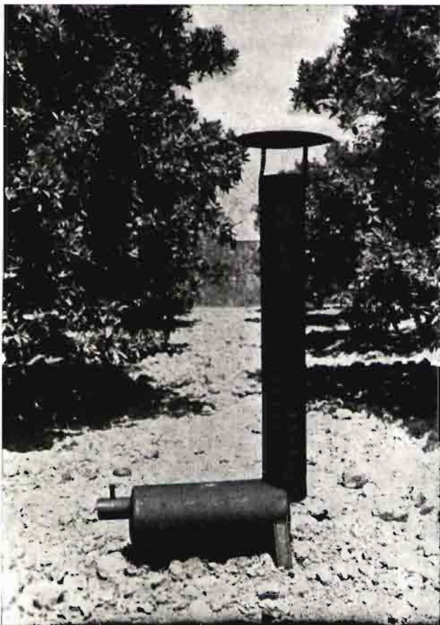
Modelo de estufa de gas-oil que ha sido clásica para la defensa contra las heladas en las plantaciones de agrios
