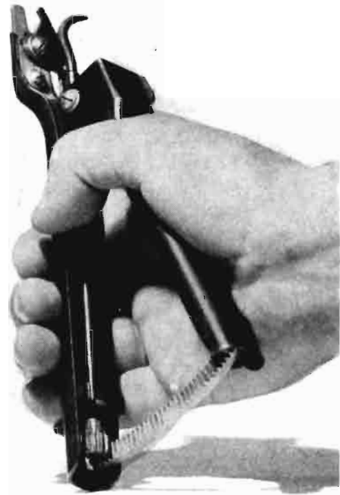
Una novedad sencilla, práctica, interesante fue la atadora para palmeta ATAFIX, presentada por Comercial Agrícola Bablia, S. L., un buen ingenio que se implantará rápidamente entre los podadores y agricultores españoles. Su funcionamiento es sencillo. Las ataduras las realiza con una cinta de plástico, por cuyo interior lleva un fino hilo metálico; el nudo se realiza de forma que puede ceder al crecimiento de las ramas, pero sin soltarse, pudiendo durar varios años, lo que economiza varios repases
