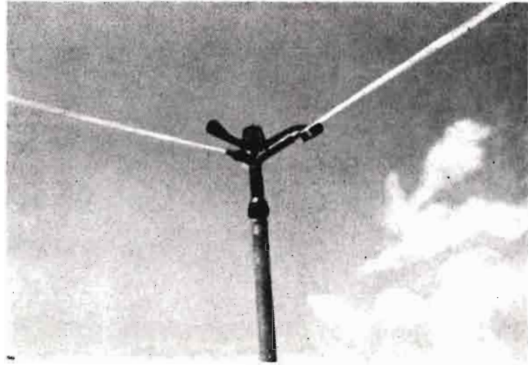
Detalle de un aspersor del sistema Portagrid que tiene la ventaja de su movilidad en una instalación fija
