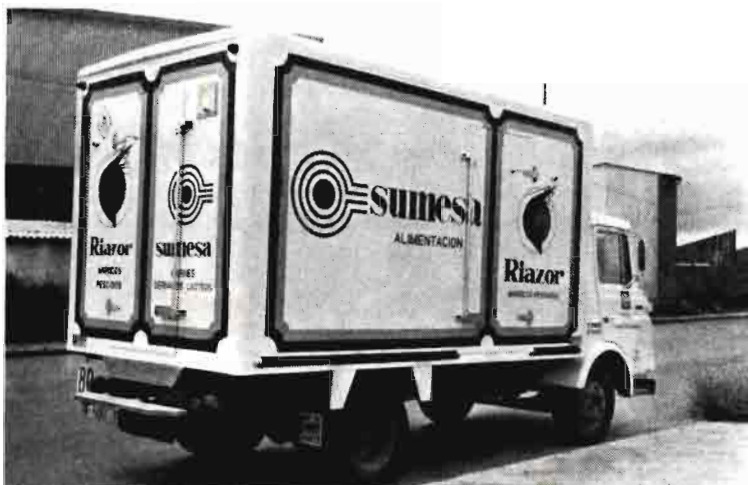
Para transporte de marisco y carne congelada, a base de equipo de refrigeración por nitrógeno líquido y temperatura de transporte de -18^{\circ}\text{C} (Citsa)
