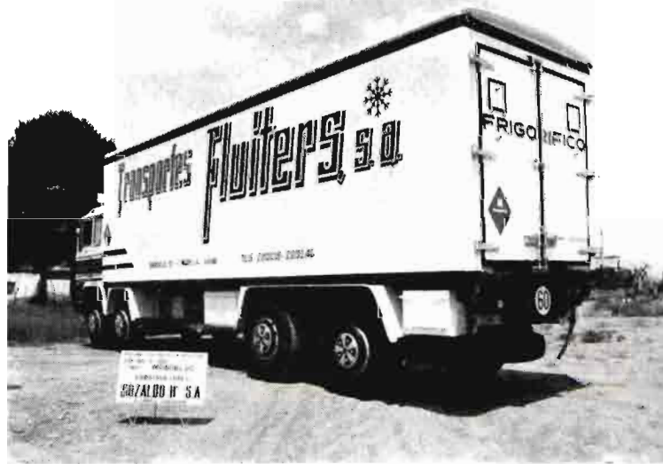
Furgón frigorífico Gozalbo , instalado sobre vehículo de cuatro ejes. Técnica de fabricación Poliéster Monoblock mediante estratificación de poliéster, fibra de vidrio sobre un núcleo interior de poliuretano de 40 Kg. por metro cúbico de densidad. El equipo frigorífico con que va dotado le permite mantener una temperatura interior de -25^{\circ}\text{C} contra un ambiente exterior de +35^{\circ}\text{C} . (Gozalbo Hermanos, S. A.)
