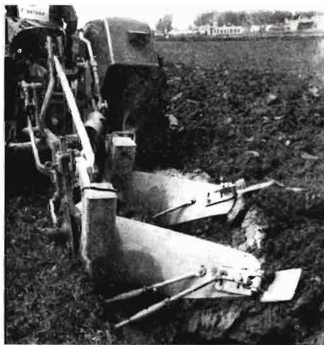
La perfecta elección de los accesorios: cuchilla, raedera, orejeta, etc., es fundamental para ejecutar una labor de acuerdo con las condiciones del terreno. La orejeta móvil se ha incorporado plenamente al apero de competición. (Foto: LABOREO)
