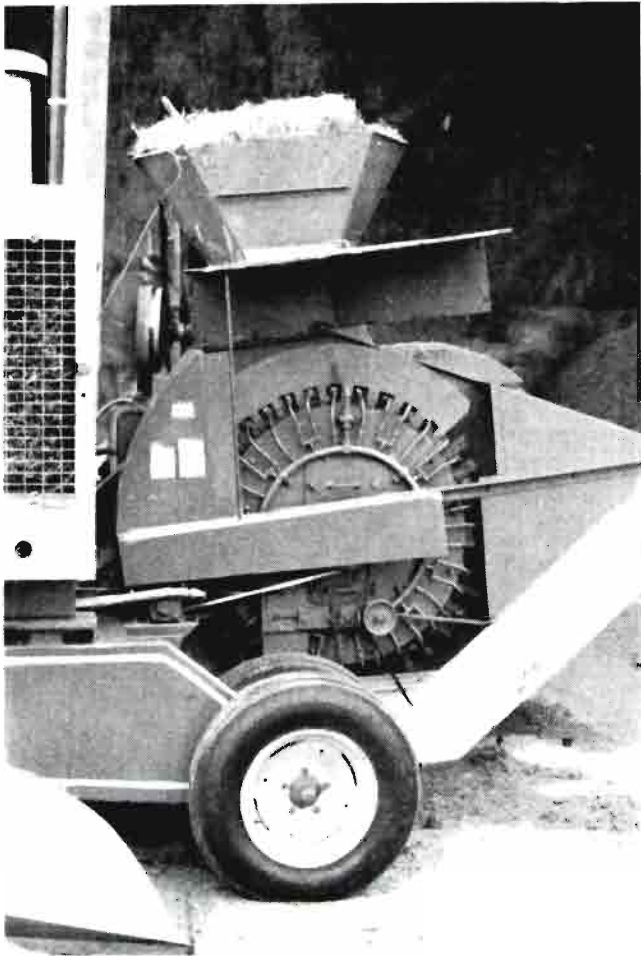
Vista de la matriz de la empastilladora de forraje en la granja sin la coraza de protección. (Foto CNEEMA)
