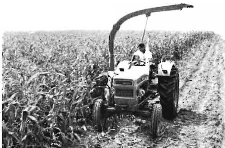
El picado del maíz forrajero facilita su manutención y ensilado. Picadora FIAT-SOMECA S. 10 en acción
