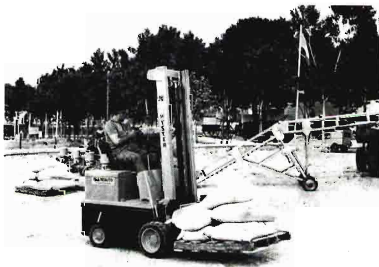
La racionalización de las operaciones de transporte de productos ensacados encuentra su máximo exponente en el empleo de carretillas elevadoras transportadoras, que facilitan las operaciones elementales de traslado de almacén y en la propia parcela de aplicación. En la foto se observa una máquina elevadora de «palets» específica de movimientos de material en almacén, aun cuando en la Demostración que nos ocupa actuó una carretilla (Anjus) adecuada para transporte y manejo en el propio campo.
