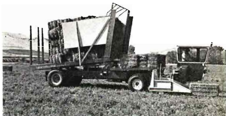
Recogedor-transportador de pacas autopropulsado. La máquina se desplaza a lo largo de una línea de pacas, recogéndo las mediante una primera plataforma lanzadora. Esta plataforma es abatible y lanza el material a otra plataforma móvil sin fin para transporte y descarga automática.
