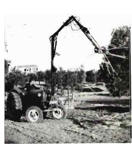
Arrancador mecánico consistente en un brazo articulado que se acopla a un tractor para su accionamiento por el sistema hidráulico. El extremo del brazo está constituido por un cilindro en posición transversal sobre el que se insertan varias series de varas de caucho que realizan el vareo por rotación del cilindro
