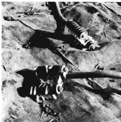
Arrancador mecánico compuesto de un cabezal soportado por pértigas que toma movimiento de un grupo motor a través de cables de torsión. En la fotografía pueden observarse los cabezales móviles a base de un par de cilindros sobre los que se insertan varios pivotes, que son los encargados de golpear las ramas
