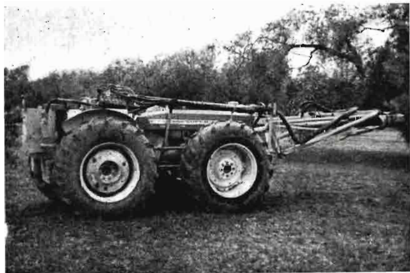
Vibrador de troncos de gran eficacia adaptado al frente de un tractor que, con otros vibradores, causa siempre gran impresión entre los numerosos asistentes a estos Concursos y Demostraciones
