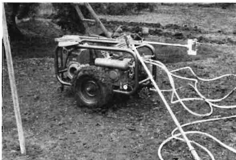
Arrancador mecánico accionado por un grupo compresor que manda aire a través de mangueras hasta los cabezales. El extremo del cabezal es móvil y consta de un peine, que realiza un movimiento de vaivén
