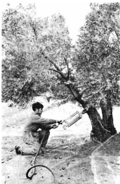
Vibrador neumático de tronco y ramas independizado del elemento de tracción. Este aparato constituyó rigurosa novedad y está indicado para trabajo en olivares situados en terrenos en pendiente donde no tienen acceso otras máquinas
