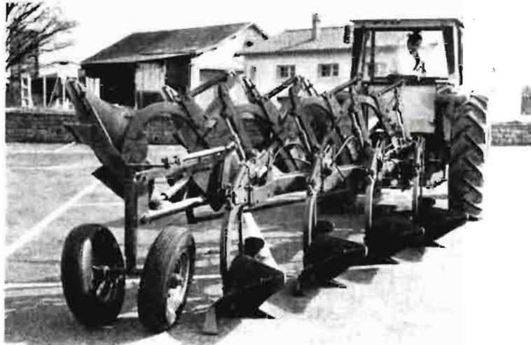
Máquina mencionada (núm. 22). Arado polisurco para labor llana. Se trata de un arado reversible con cuerpos que se retraen. Soc. VIAUD
