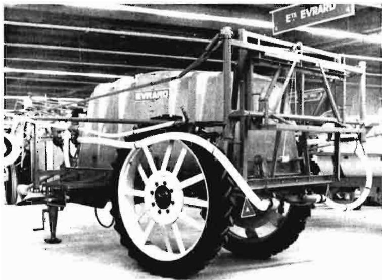
Fig. 1.—Pulverizador de chorro eyectado Evrard, especialmente equipado para fertilizantes en suspensión. (Documento SIMA.)
