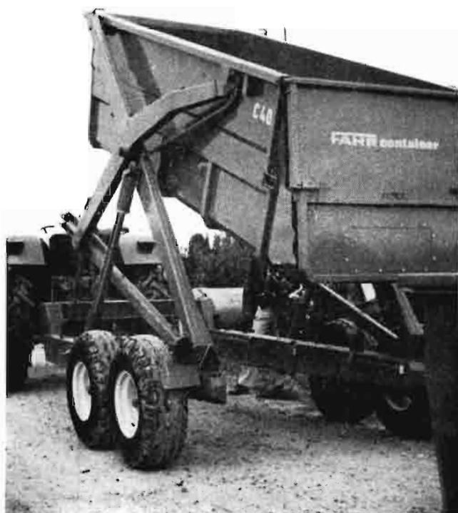
Posición de descarga trasera del contenedor FAHR, al bascular mediante la acción de poderosos cilindros hidráulicos
