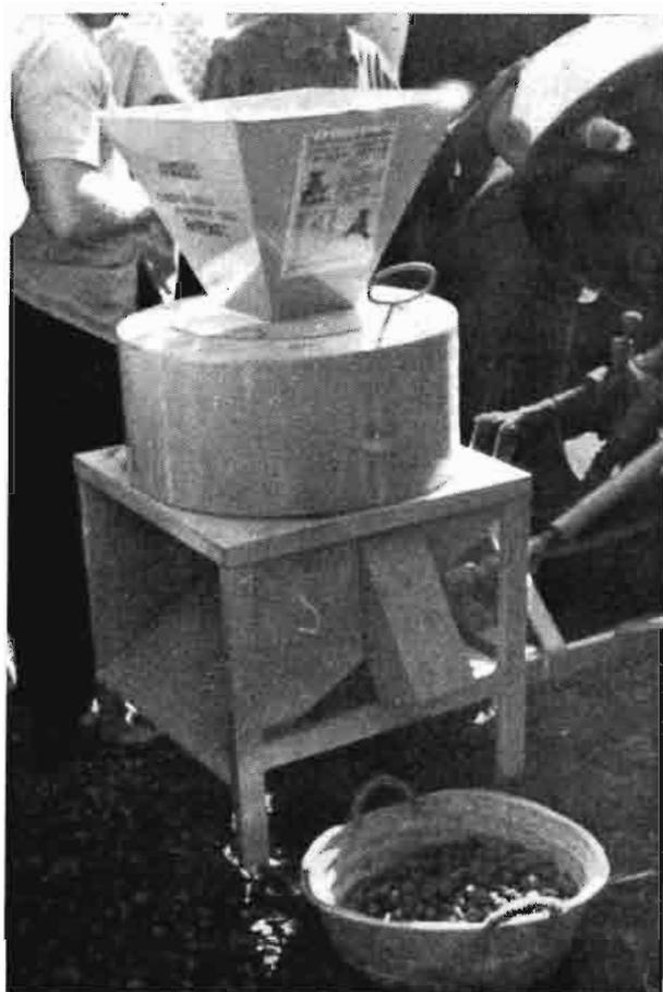
Una máquina peladora, que funciona acoplada a la toma de fuerza del tractor o accionada con motor de gasolina, se presentó a la demostración de Palma. Su rendimiento es bajo y puede ser útil en pequeñas explotaciones.
