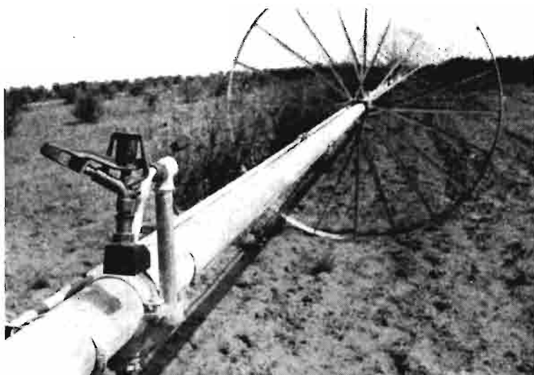
Vista parcial de un tramo con un aspersor del sistema autopropulsado por medio de ruedas motrices que cambian la posición de una línea de 500 metros mediante el movimiento que imprime al sistema un pequeño motor de 3 CV.
