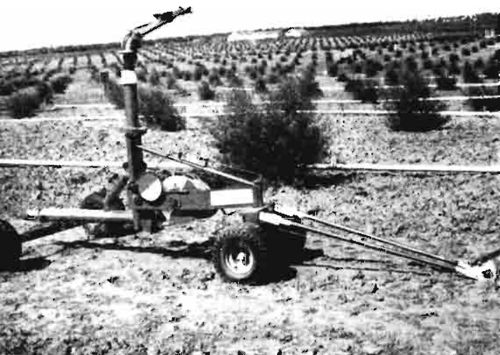
Aspersor autopropulsado que se desplaza a lo largo de una línea con una velocidad de 15 a 60 metros/hora. El radio de acción es de 50 a 65 metros, y el caudal, de 35.000 a 110.000 litros/hora
