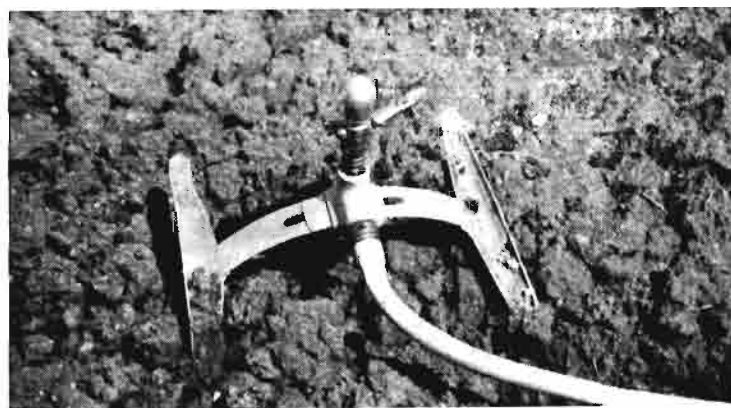
Aspersor montado sobre un trineo que facilita considerablemente los desplazamientos mediante manguera de material sintético enrollable en un tambor
