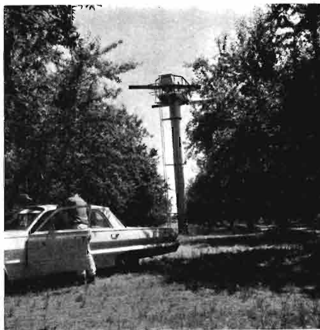
Los cuidados prestados al almendro en California (Estados Unidos) son admirables. Se presta especial cuidado a la polinización con el concurso de abejas, a la defensa de las heladas a base de ventiladores torre, como se aprecia en la foto, o estufas.
