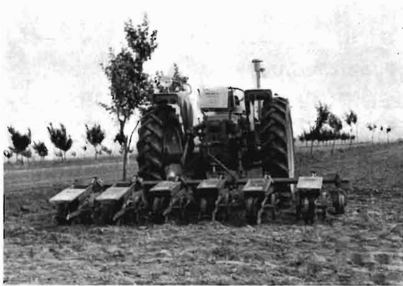
Sembradora de precisión de seis cuerpos dispuesta a lo largo de una barra portaaperos. Como puede apreciarse, consta de una tolva superior, un par de discos que ruedan sobre el terreno regulando la caída de semilla y una rueda posterior que aprisiona debidamente la tierra a lo largo del surco donde se va efectuando la siembra
