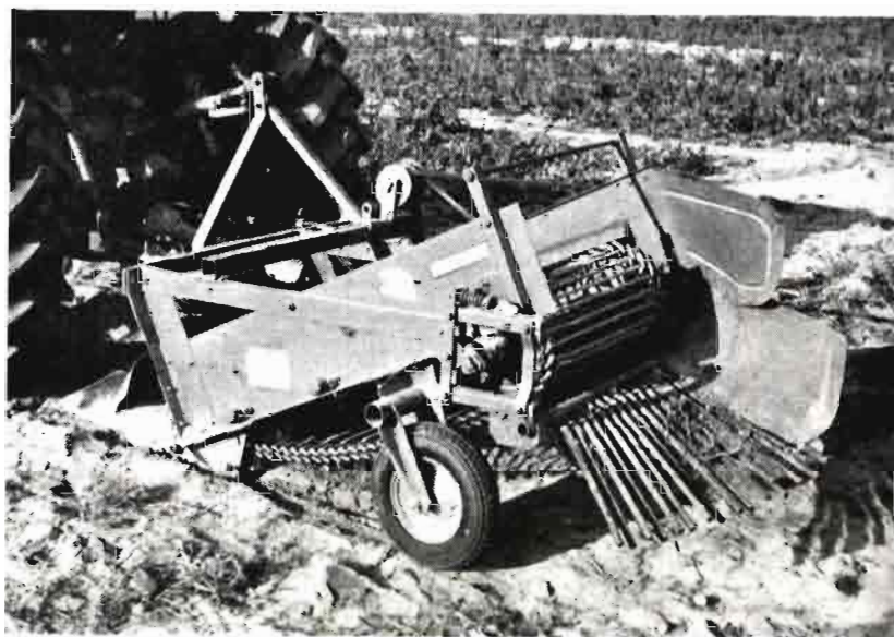
Arrancadora-hileradora con sistema limpiador de cadena sinfín. La reja excavadora deposita un volumen de tierra, junto con los tubérculos, en la banda transportadora que a lo largo de su recorrido elimina la tierra. Este tipo de máquinas realiza una buena limpieza en condiciones de terrenos arcillosos y húmedos. Lateralmente lleva acoplada una desbrozadora que trabaja en paralelo con el arrancador, simultaneando ambas operaciones
