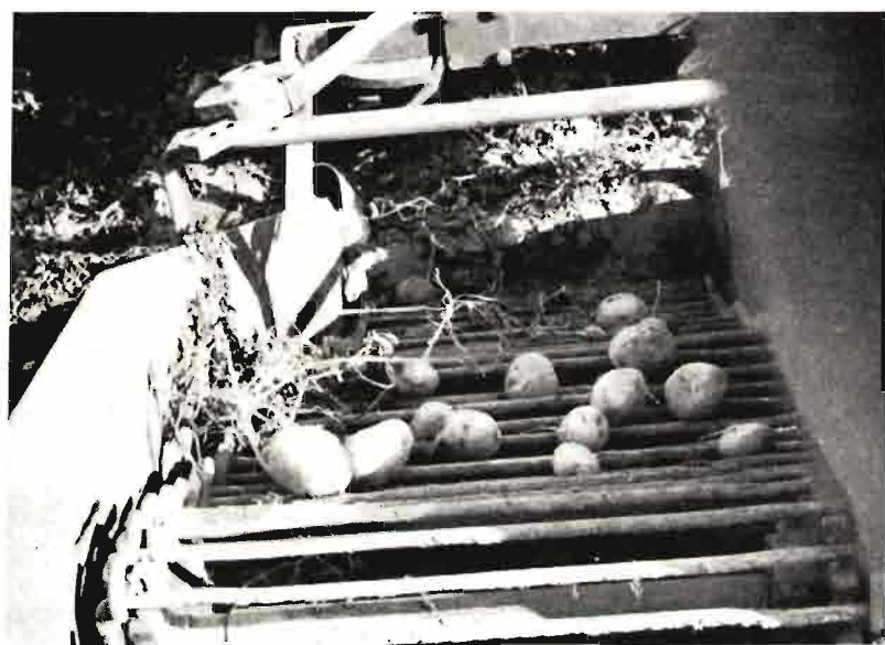
Detalle de la primera banda sinfín de una arrancadora con mecanismo limpiador de cadenas. Pueden observarse los tubérculos mezclados con la tierra y los tallos en el momento de ascender hacia la segunda banda deflectora, que los depositará en el terreno completamente limpios
