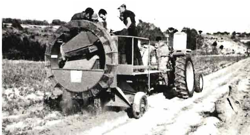
Cosechadora de gran rendimiento, de fabricación alemana. Puede observarse en la fotografía el tambor limpiador de cangilones que deposita los tubérculos en una plataforma donde los operarios se encargan de realizar las operaciones de clasificación y ensacado
