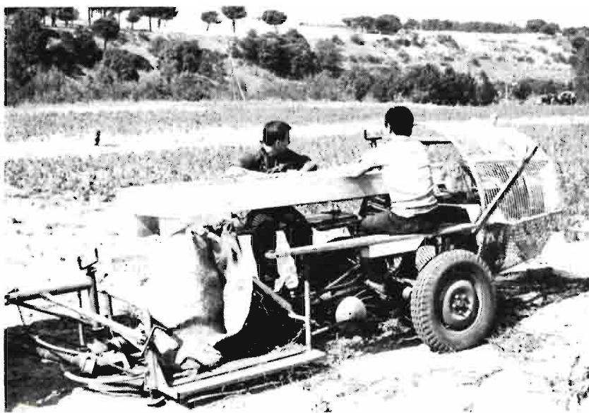
Cosechadora alemana de sencillo diseño y buenas características de funcionamiento. La excavación se efectúa por cuchillo de media luna o angular en V, y el sistema de limpia, por tambor giratorio provisional de barrotes de hierro. Se aprecia en la fotografía la plataforma clasificadora donde los operarios realizan esta operación
