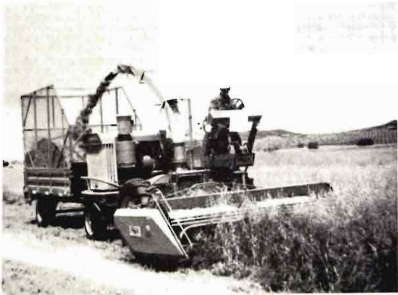
Cosechadora picadora de forraje autopropulsada. Realiza la operación de siega por el sistema de barra de corte con empujadores, pasando el porraje posteriormente a la cámara de picado, de donde sale impulsado por la chimenea a un remolque situado en la parte posterior
