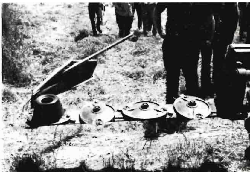
Segadora rotativa de tambores planos situados en una barra transversal. Van provistos de cuchillas diametralmente opuestas que se retraen al encontrar un obstáculo
