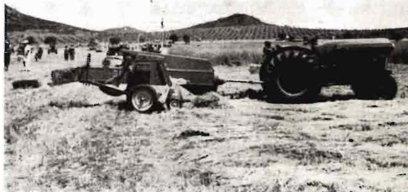
Recogedora empacadora remolcada y accionada por la t. d. f. del tractor. Recoge el forraje por un sistema de «pick-up» y realiza el prensado mediante un émbolo empacador. Las «pacas» quedan depositadas y alineadas en el terreno para su posterior recogida
