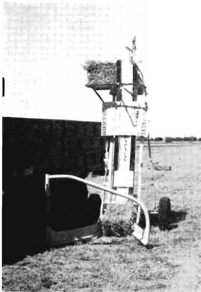
Cargador de pacas, también llamado «Aupa-pacas», adosado a la parte lateral de un camión. El movimiento del mecanismo elevador se toma a través de dos ruedas neumáticas que le sirven de soporte. Se observa la plataforma superior con una «paca» depositada, donde un operario se encargará de manipularla en el camión o remolque
