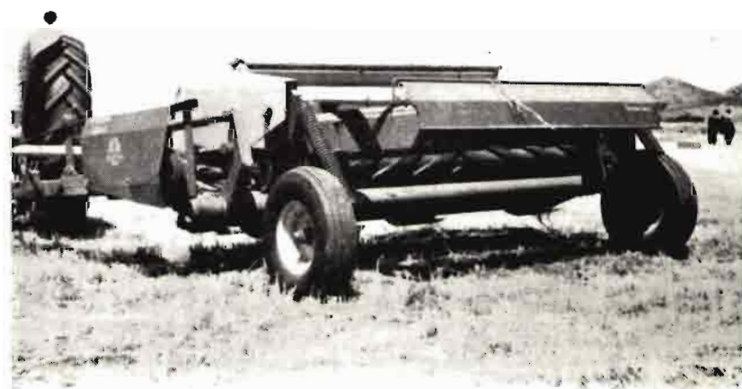
Segadora acondicionadora hileradora arrastrada y accionada por la t. d. f. del tractor desplazada respecto al eje frontal. El mecanismo acondicionador consta de dos cilindros que giran en sentido contrario, quebrando los tallos del forraje, con lo cual se facilita la deshidratación. Una embocadura posterior se encarga del hilerado
