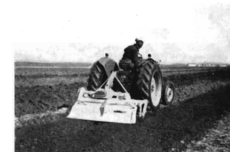
Rotocultor con 32 elementos o azadas, que puede trabajar a un ancho de unos 1,50 metros y a una profundidad de unos 20 centímetros
