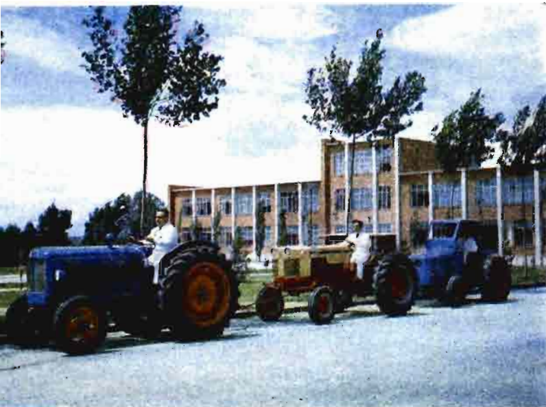
Determinación de potencia a la barra en pista artificial, con carro dinamométrico
