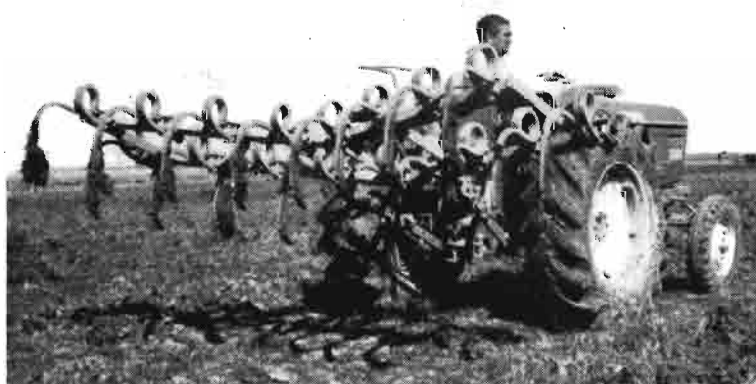
Cultivador de 17 elementos y ancho de trabajo de 3,40 metros
