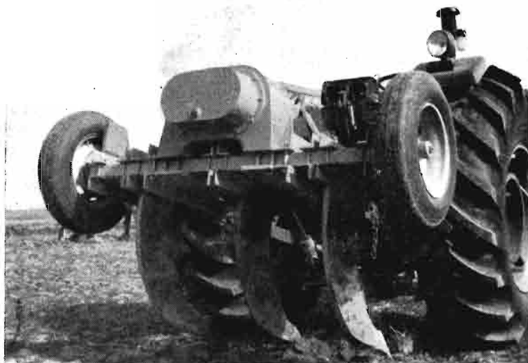
Subsolador vibrador de tres brazos, acoplado a los tres puntos del tractor
