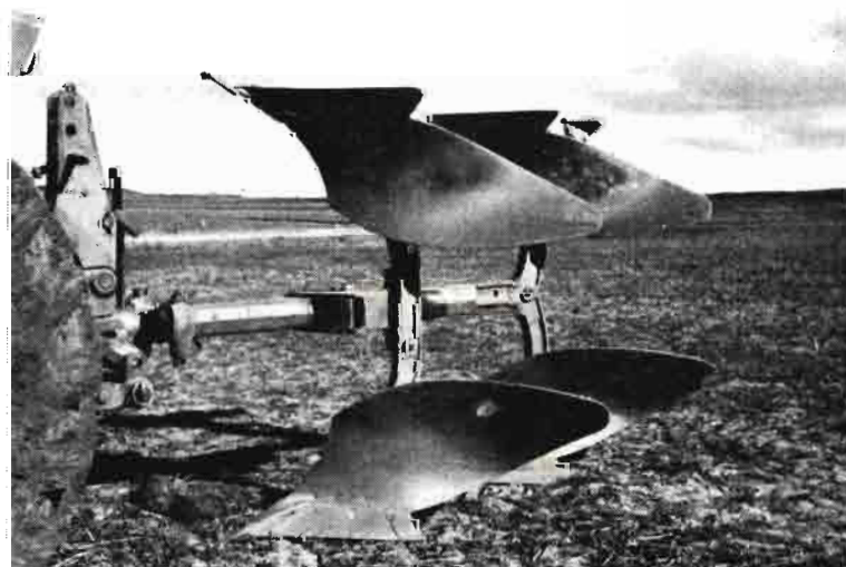
Bisurco reversible de gran profundidad de labor
