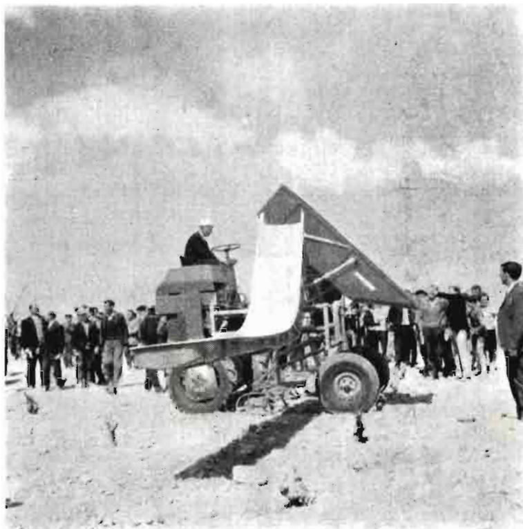
El depósito de carga de los racimos puede bascular para la más fácil descarga de la vendimia
