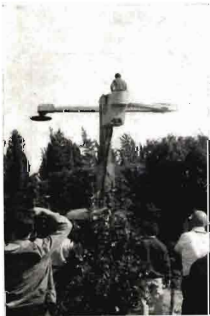
La poda mecanizada de los agrios —sobre todo la de los limoneros— permite la acción de discos-cuchillas que cortan o rebajan los árboles de forma horizontal. Con esta operación de poda obligada los árboles se conducen en forma de setos, en cuyas paredes aparece la fructificación de los limoneros en forma accesible a la recolección
