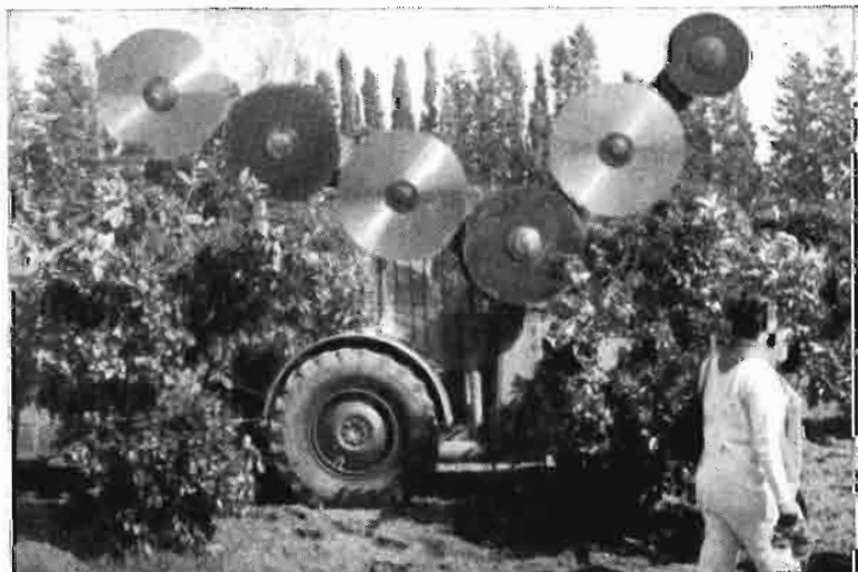
Debido a dificultades de disposición de mano de obra especializada para la poda de los naranjos se dispone en Israel de máquinas de poda mecanizada que «rebajan» las ramas de los árboles con cortes orientados en este caso de modo vertical, por medio de discos cortantes, que actúan como cuchillas, situados en un mismo plano
