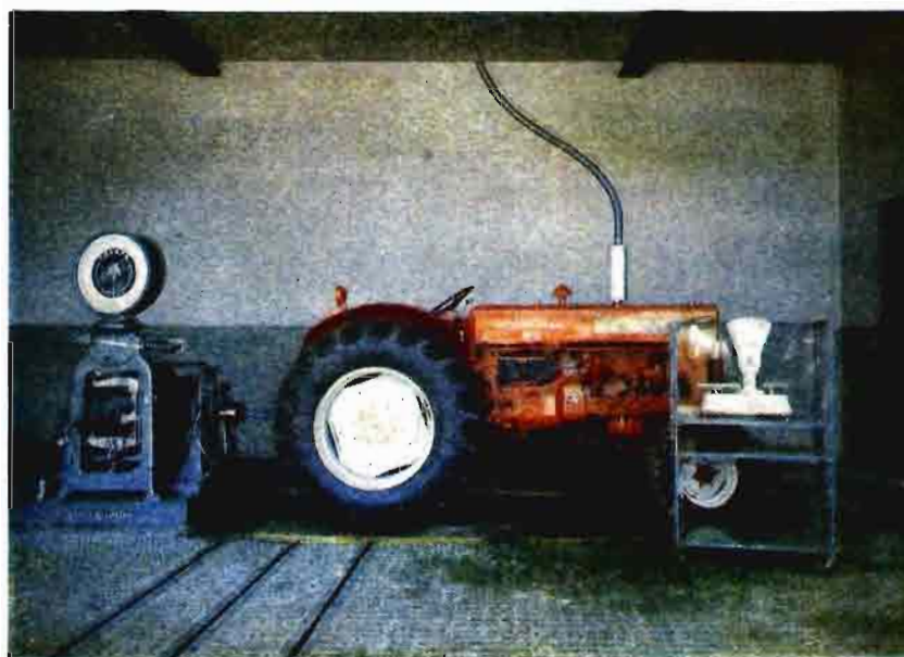
Ensayo a la toma de fuerza. Freno de inducción
