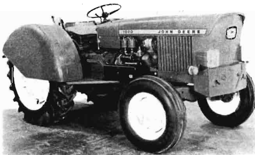
Nuevo tractor John Deere, modelo 1020 LU Compacto, de 47 CV al motor, especialmente diseñado para la mecanización de nuestros viñedos y frutales
