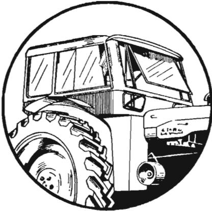
Estas cabinas se desmontan sin necesidad de herramienta alguna. Con sólo aflojar los cuatro cierres cartola queda separada del tractor
