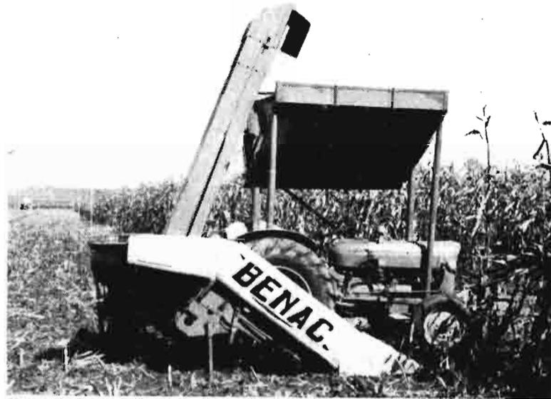
Recogedora de mazorcas de una sola línea, mostrando el sistema embocador y el transportador-elevador de las mazorcas ya sin bractear
