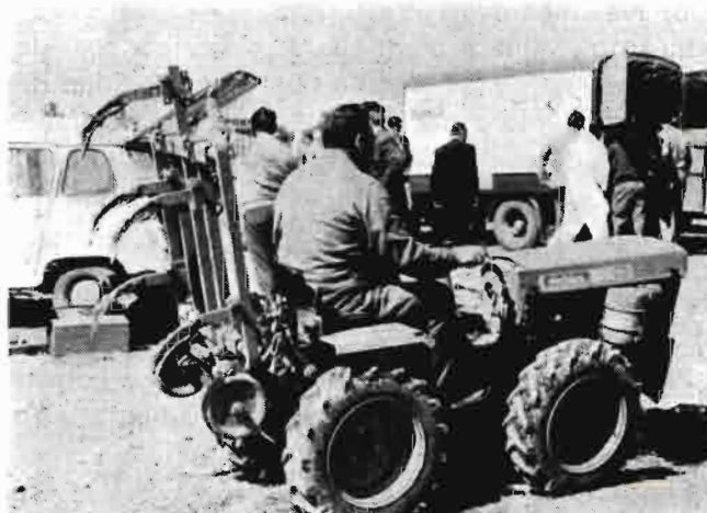
Una característica interesante de los pequeños tractores viñeros es la de poder elevar los aperos a la posición vertical, con el fin de maniobrar en menor espacio entre las vides
