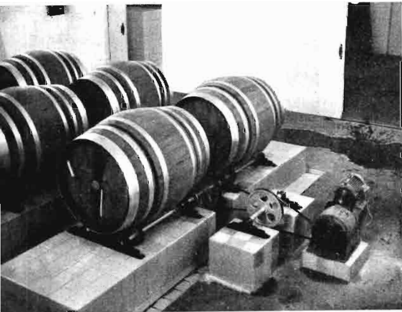
Sistema rotativo de elaboración de vinagres vínicos del Pabellón de Vinagrería de la Escuela de la Casa de Campo
