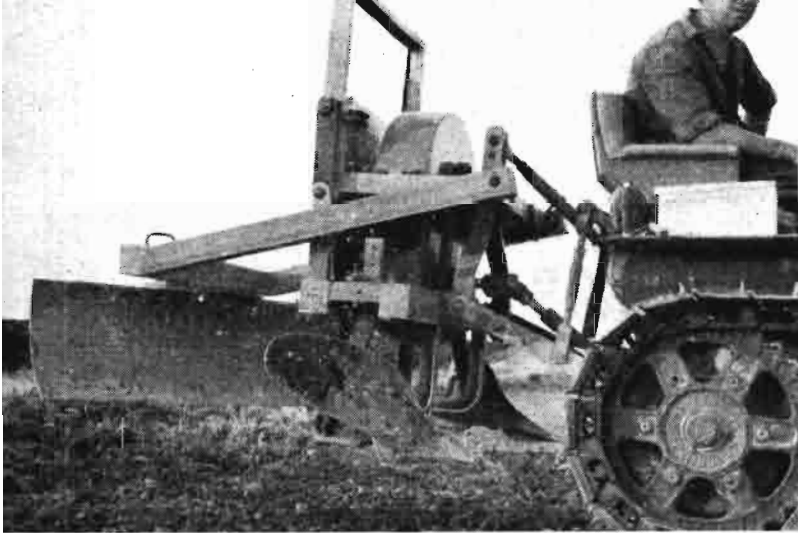
La pala alumbradora o serpiadora deja el terreno cuadrículado, como en la alumbra tradicional, sólo que el centro de la pileta queda ahora en la calle y no en la cepa
