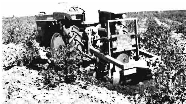
Pala alumbradora «Agrice» para realizar series de piletas entre las líneas de cepas con el fin de retener el agua de lluvia a disposición de las plantas
