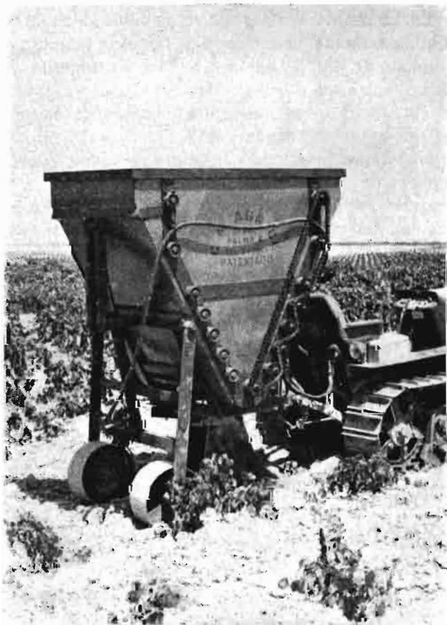
Localizadora de estiércol que, dotada de una tolva para 600 kilos, provista de un sistema de agitadores y un sinfín con hélices, lleva el estiércol a profundidad de 30-40 cm.
