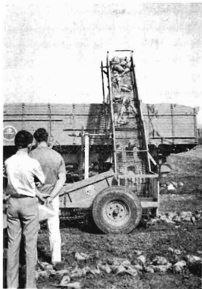
Recogedora cargadora de gran rendimiento, que actúa simultáneamente con un camión o remolque, recogiendo la remolacha extraída e hilerada y elevándola por medio de una cinta transportadora
