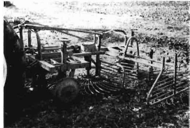
Arrancadora hileradora. La remolacha extraída pasa a un tambor giratorio que sirve de limpieza y la deja hilerada, pudiendo luego recogerse a mano o con una recogedora cargadora
