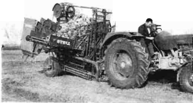
Cosechadora integral de remolacha, en la que se aprecia la tolva de raíces y la de descarga automática de hojas y coronas
