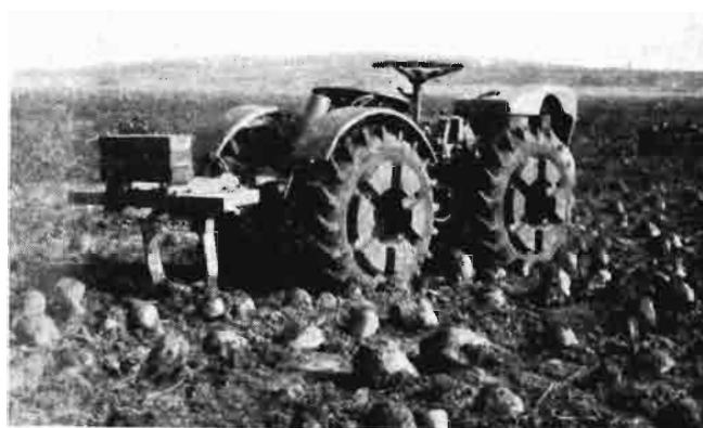
Arrancador mecánico montado sobre tractor articulado, que trabaja sobre una línea previamente descoronada, con bastidor sobre el que apoyan contrapesos para facilitar la penetración en tierras fuertes. Los brazos son independientes, regulables en el bastidor según el tamaño de la remolacha
