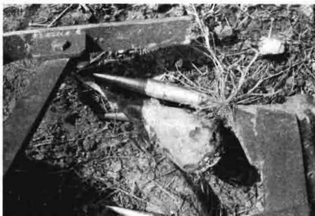
Detalle de un arrancador mecánico compuesto por dos formones de punta cónica en quilla, en el que se aprecia la calidad del sistema de arranque La remolacha va previamente deshojada por uno de los equipos descompuestos
