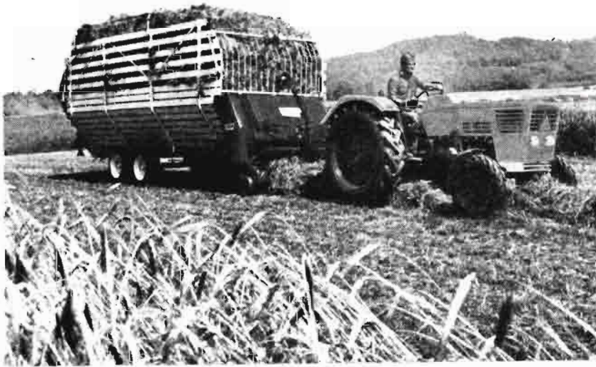
Remolque autocargador y autodescargador, muy útil para ensilaje y sobre todo para consumo en verde por el ganado. Necesita segado-hilerado previo
