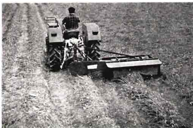
Segadora rotativa con dos tambores de corte que deja las hileras hechas y tiene un elevado rendimiento
